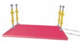
Posizionare il 2° pannello, e bloccare le vite a doppio effetto basculante "MA" complete
